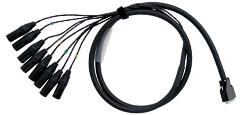
オス DB25 コネクターは、AES59 に準拠した 8 チャンネルのピン配列規格に従って配線されています。丈夫で耐久性のある金属製で、ロックネジが付いています。数多い嵌合回数で、ピンは金メッキされています。ブレークイン / アウト側の各 XLR コネクターには色分けされたリングが取り付けられており、1 ~ 8 の番号が付けられています。DB ケーブルには、カスタムラベルを貼るための透明な熱収縮性シースと、再度利用できるケーブルストラップも付いています。
