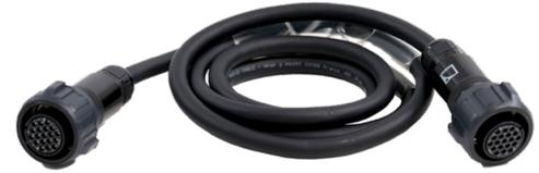
DOM ケーブルは 19 ピンの CA-COM コネクタを使用し、そのうち 18 ピンは 6 チャンネルのバランスアナログオーディオを伝送するために使用されます。
