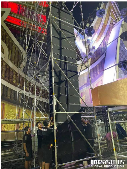
メインPAは、片側16台のK2と6台のK1-SBで構成
